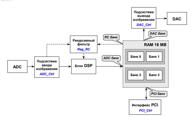
Присвоив банкам памяти мнемоническое имя модуля, который к нему в текущий момент времени обращается за данными, получим PCI, ADC и DAC банки. Номера банков определяются соответственно битами D[1..0] регистров PCI Ctrl, ADC Ctrl и DAC Ctrl.
