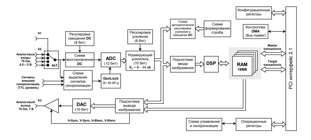
Рис. 1. Функциональная схема видеопроцессора RT-825.
