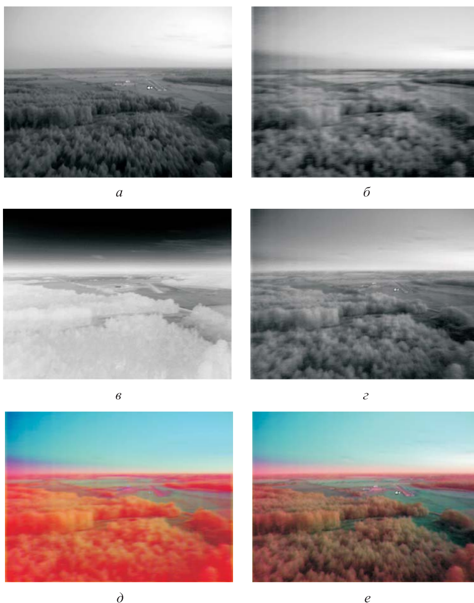
Рис. 2. Сравнение результата цветного комплексирования с простым усреднением ТВ, ИК и ТП изображений:
