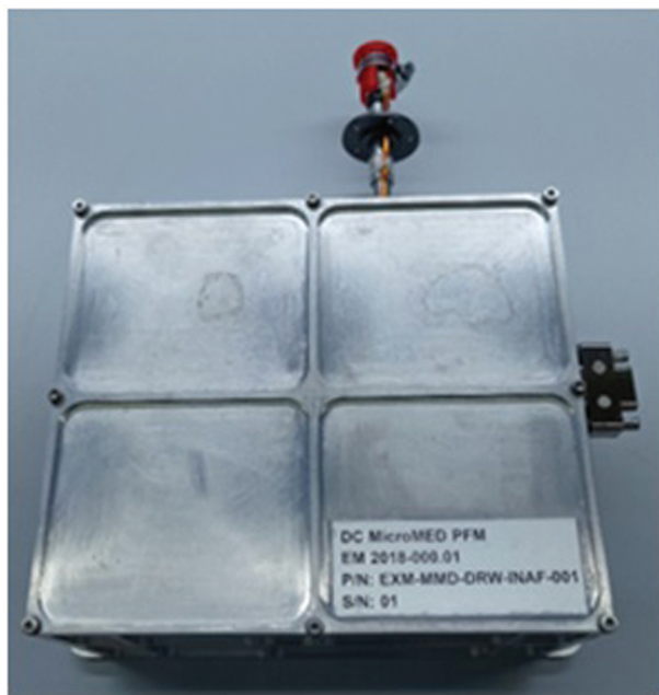
Рис. 4. Внешний вид блока MicroMED. Крышка на трубке забора образцов атмосферы (в верхней части рисунка) снимается перед запуском.
