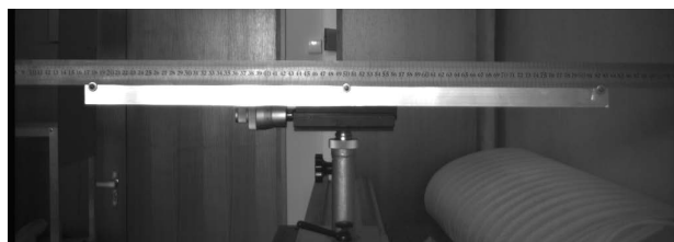
Рис. 7. Измерение поля зрения ТВ РПМ-1.
