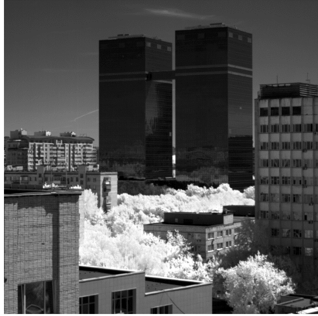
Рис. 3б. Съёмка RT-1280Lynx с ИК объективом и фильтром ИКС-1 в диапазоне от 0,8 до 0,95 мкм
