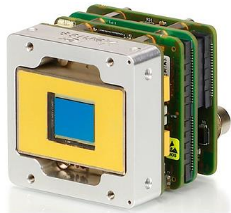
Рис. 1в. Модуль Xenics XSW-640 спектрального диапазона 0,9 – 1,7 мкм в составе видеосистемы RT-700Combo
