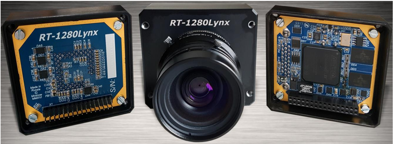
Рис. 1а. Камера Растр Технолджи RT-1280Lynx, спектральный диапазон 0,4 – 0,95 мкм
