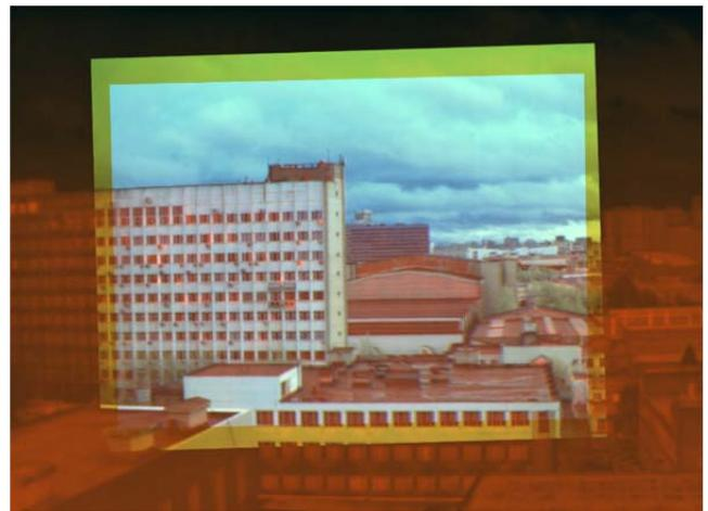
Рис. 2. Комплексирование трёх видеоканалов с совмещением полей зрения.
