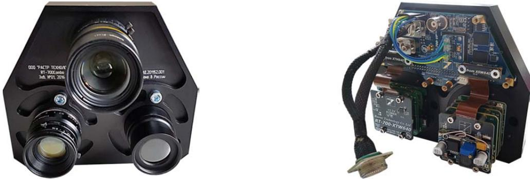
Рис. 1. Мультисенсорный блок видеосистемы RT-700Combo без внешнего корпуса – вид спереди и сзади.
