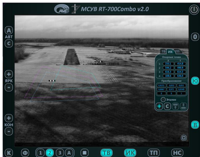
Рис. 1б. Комплексование после совмещения, показан интерфейс совмещения и опорные точки
