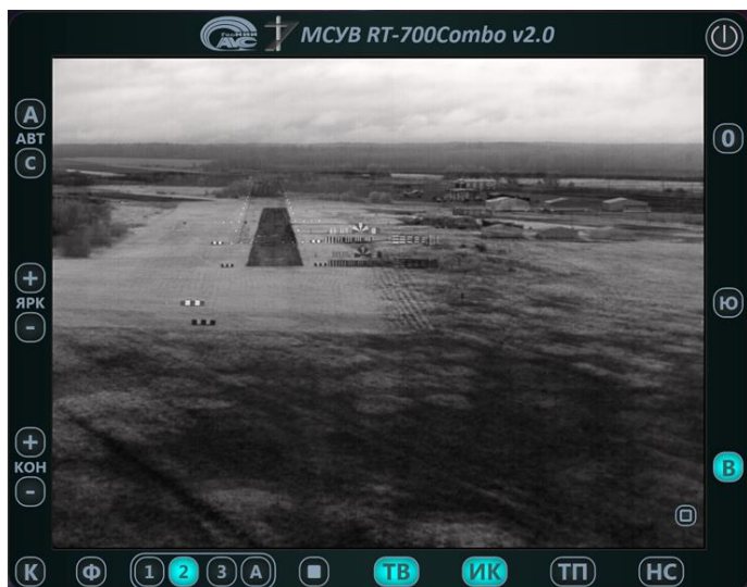
Рис. 1а. Комплексование видеоканалов без совмещения, возле взлётно-посадочной полосы поставлены оптические и тепловые миры
