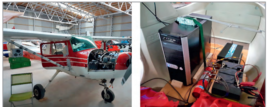
Рис. 4. Крепление и установка МСУВ RT-700Combo на борт двухместного самолёта Cessna для испытаний: слева – внешний вид; справа – установка в багажном отделении
