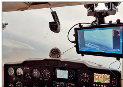
Рис. 6. Испытания МСУВ RT-700Combo, вид из кабины самолёта, на монитор выводится изображение наиболее информативного ближнего ИК-видеоканала
