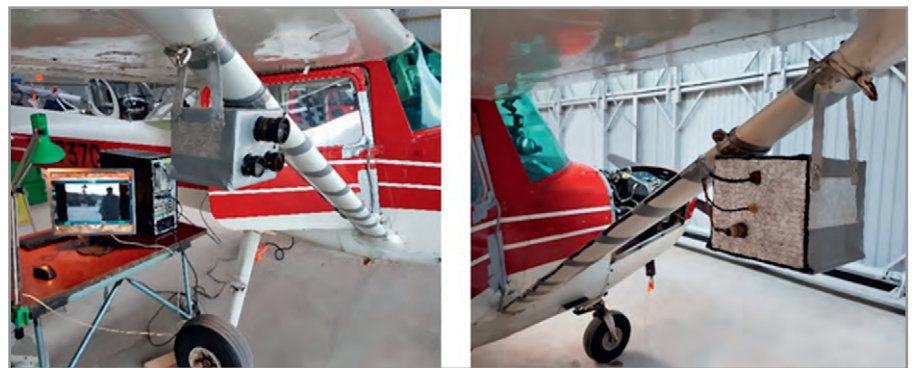
Рис. 3. Крепление и установка МСУВ RT-700Combo на борт двухместного самолёта Cessna для испытаний: слева – отладка перед полётом; справа – вид МСУВ сзади (верхний провод – коаксиальный кабель для передачи видео и навигационных данных, средний – антенна GPS/ГЛОНАСС, нижний – питание 24 В)
