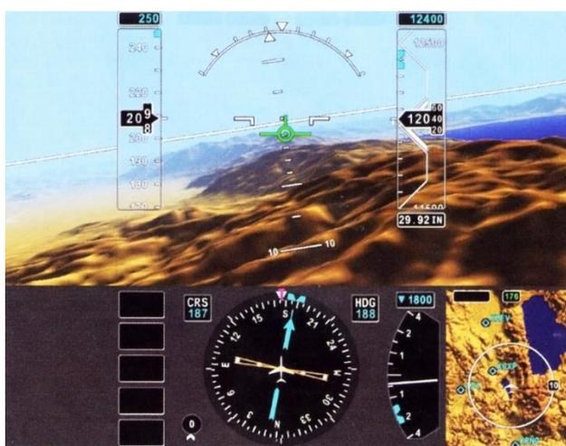
Рисунок 2. Синтезированное изображение на PFD, формируемое ССВ "Flight Logic" фирмы Honeywell
