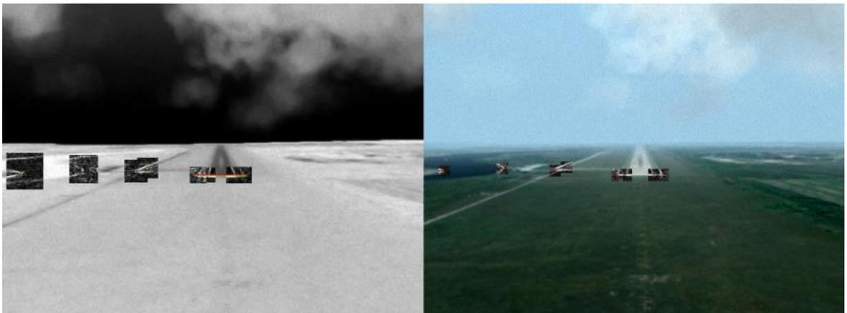
Рисунок 32. Пример отождествления ТО для разнородных изображений с шумом и размытием
