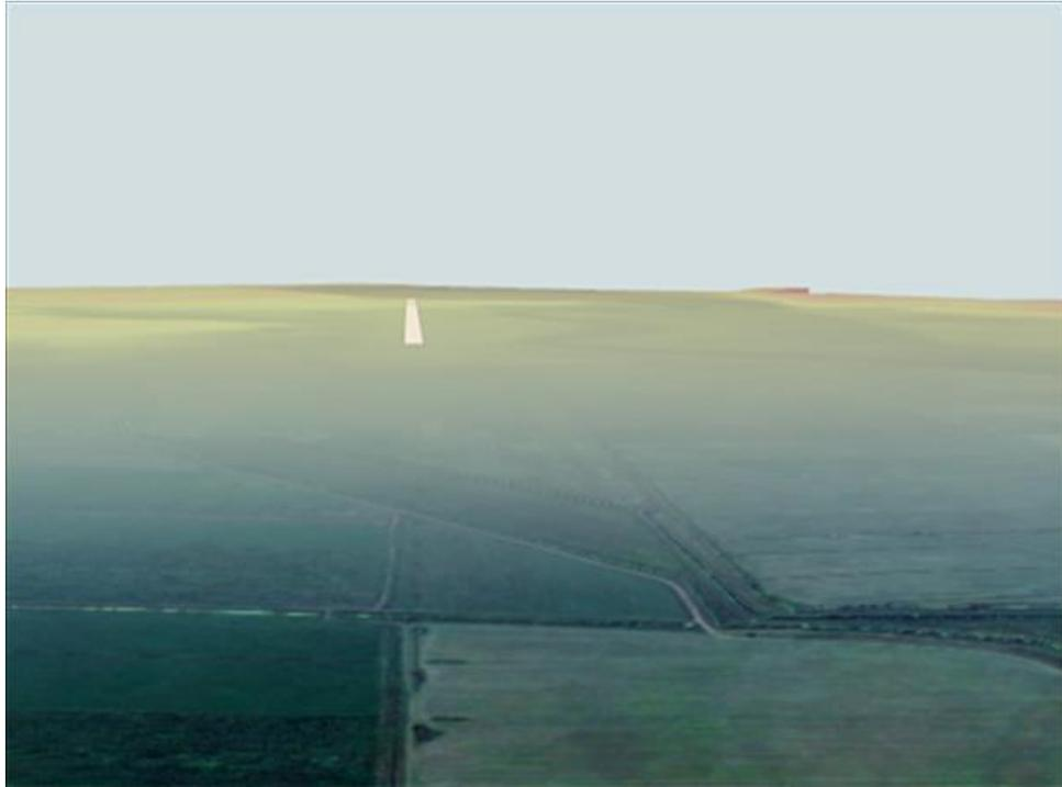
Рисунок 40. Результат комплексирования пары изображений (см. рисунки 7 и 8) с помощью 3D ФНЧ
