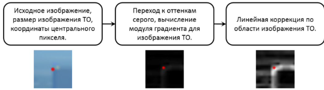
Рисунок 2. Способ формирования изображения ТО (угол здания)
