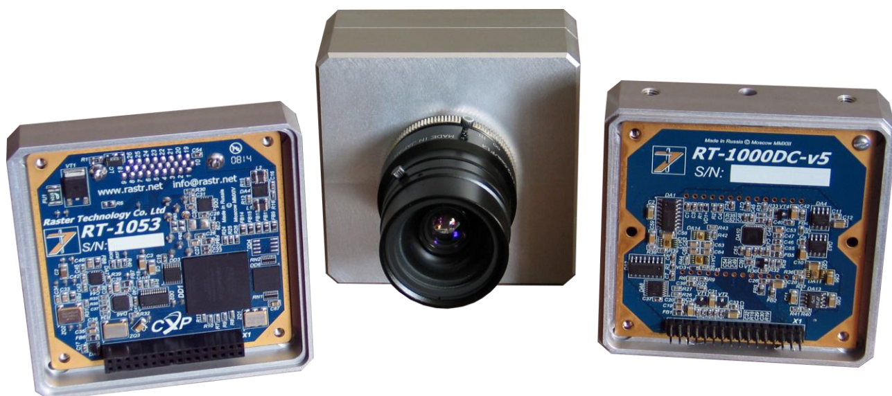
Рис. 2. Конструктив цифровой видеокамеры RT-1000DC V поколения
