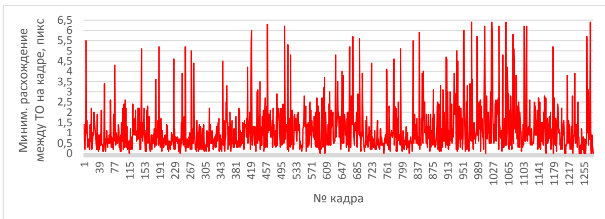
Рисунок 5. Результаты оценки качества совмещения в динамике при совмещении кадров с последующей фильтрацией
