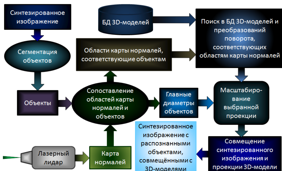
Рис. 6. Схема совмещения синтезированного изображения и 3D-моделей
