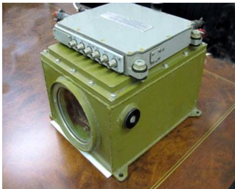
Рис.1. Видеокамера и мультиплексор в защищённых корпусах
