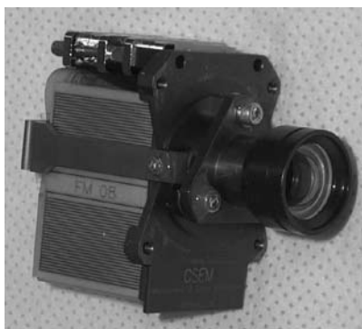
Рис. 2. Образец французской камеры технического зрения проекта «Розетта»
