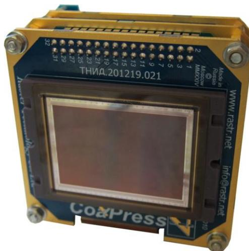
Рис. 1. Модуль фотоприёмника
