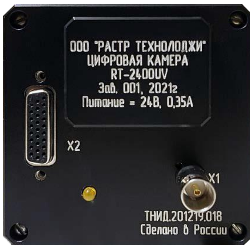
Рис. 9. Задняя панель модуля фотоприёмника
