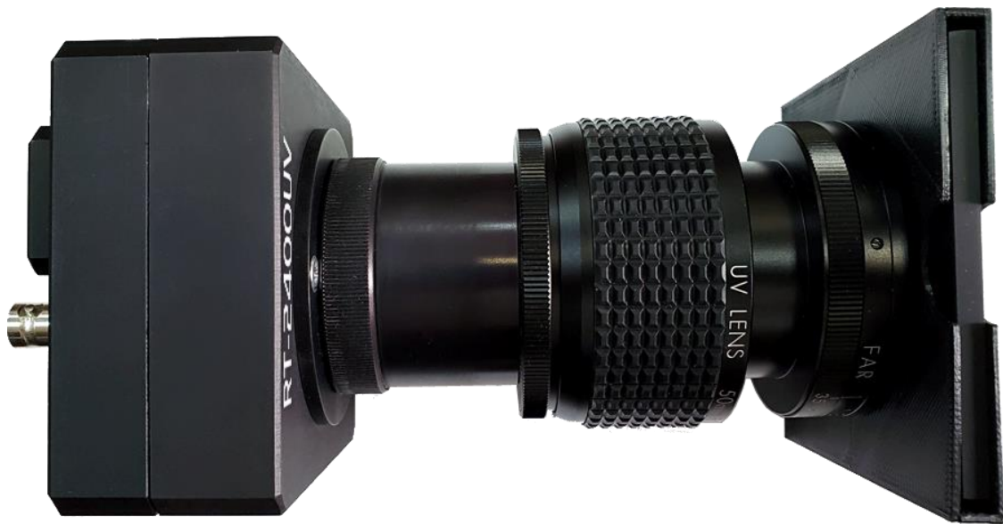
Рис. 1. Модуль фотоприёмника в сборе с кварцевым объективом 50 мм и УФ светофильтром
