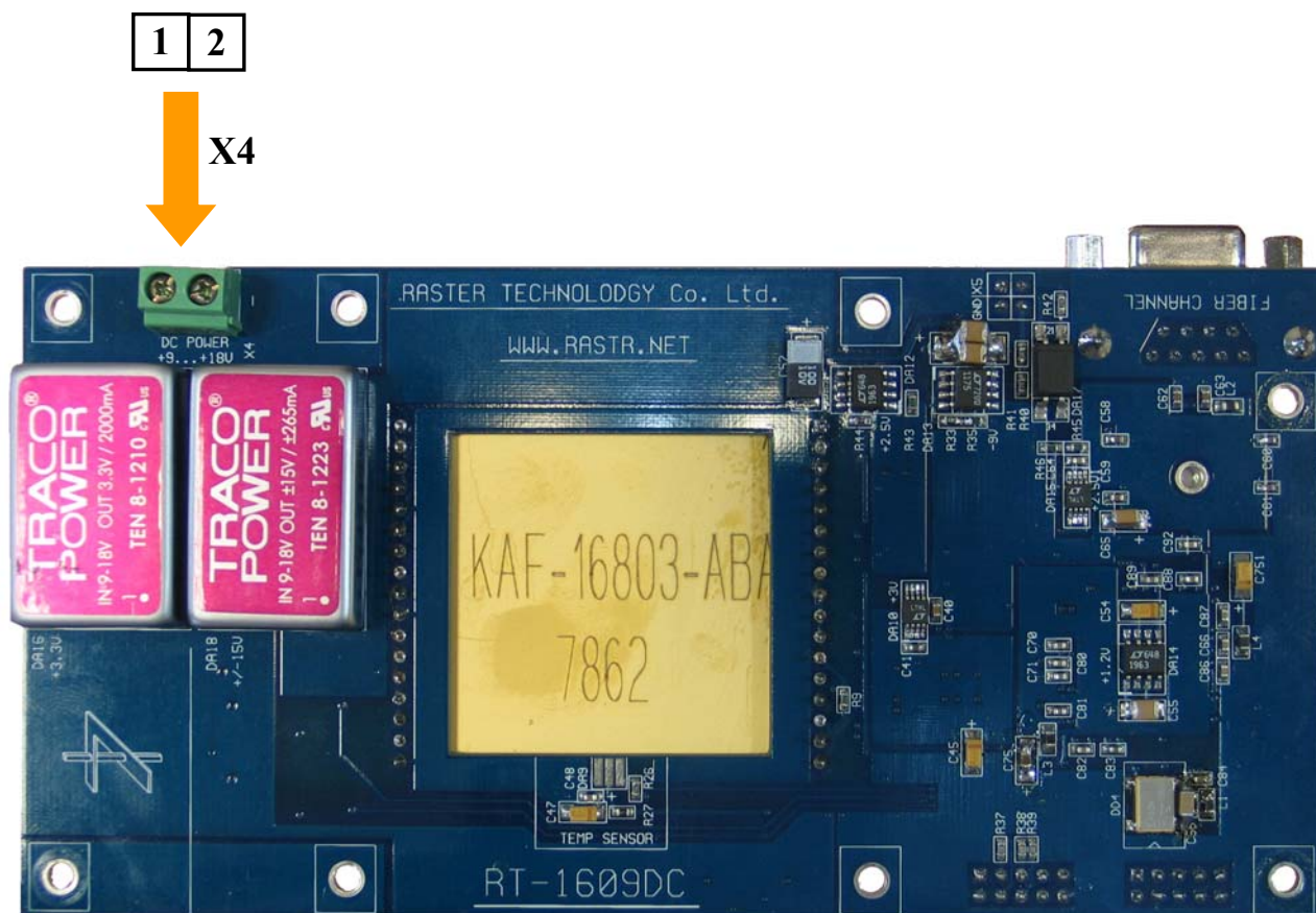
Рис.7. Положение клеммника X4 на модуле фотоприемника
